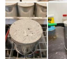
Kuvat 14a-e. Koekappaleiden valmistus betonin pinnan aukaisu, d. muotin ja b ja e. alumiiniteipin asennus muotin ja
