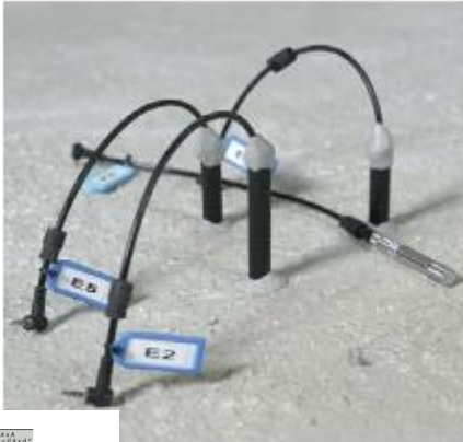
Päällystysmittapisteessä kaksi syvyyteen A ja yksi syvyyteen äksi sisäilman lämpötila mitataan ittapäällä.
