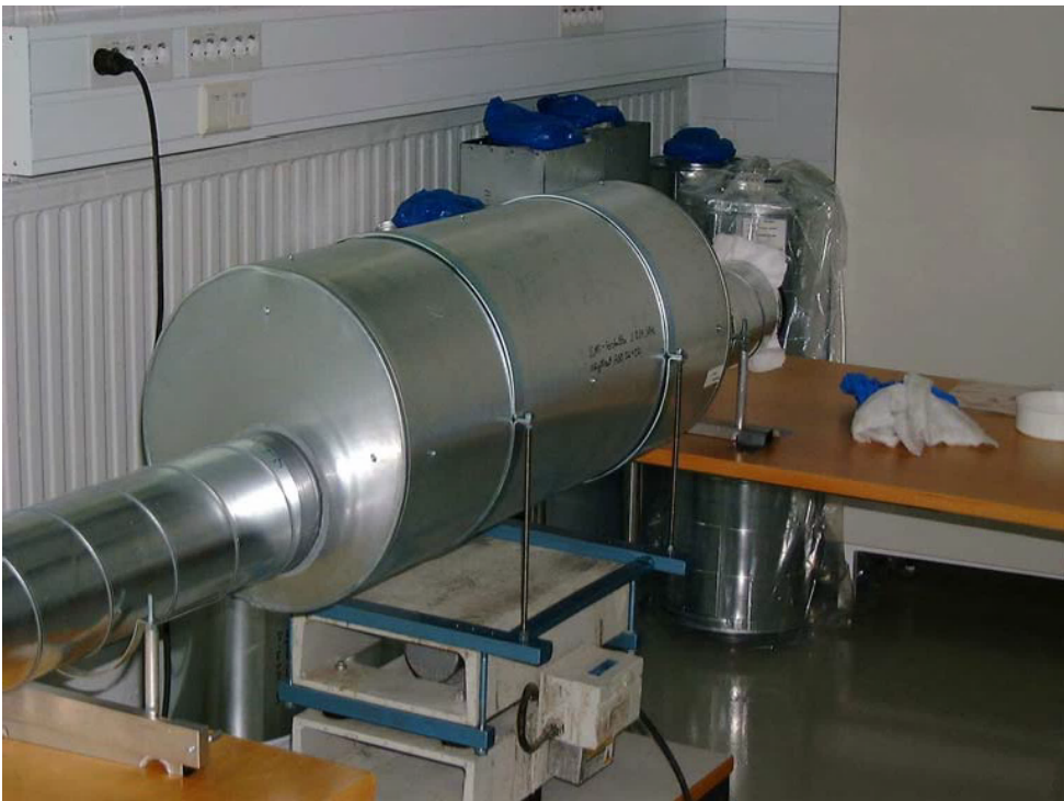
Kuva 11.2. Testattava tuote tärinäalustalla pantakiinnityksellä.
