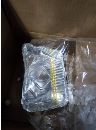
Kuva 4.5. Näytepussin sisällä olevaan vuokaan lisätään puhtaalla ruiskulla 5 ml tutkittavaa voiteluainetta.
