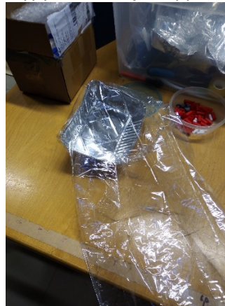
Kuva 4.4. Elintarvikelaatuinen alumiinivuoka asetetaan näytepussin pohjalle.
