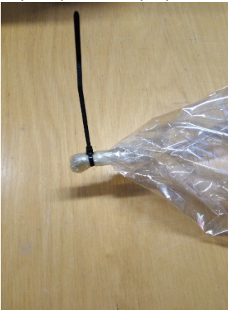
Kuva 4.3. Näytepussin tiivistys varmistetaan taittamalla ja kiristämällä.
