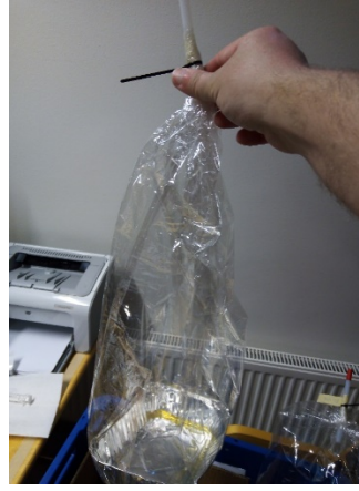
Kuva 4.6. Näytepussi tiivistetään teflonputken ympärille, jonka kautta pussiin johdetaan puhdasta paineilmaa.
