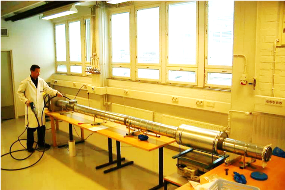
Kuva 11.3. Puhdistettavuus- eli harjauskokeessa pyörivä harja työnnetään kanavaan ja testattavaan tuotteeseen.
