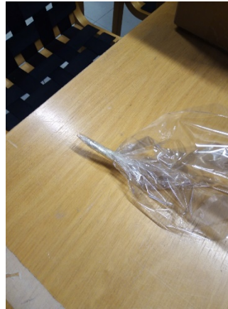
Kuva 4.2. Näytepussin pohja tiivistetään ”rypyttämällä” ja teippaamalla pussi.
