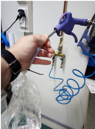
Kuva 4.7. Paineilmalla täyttämisen jälkeen näytepussit tulpataan ja hajuyksikkö [OuE/m 3 ] määritetään standardin EN 13725:2022 mukaisesti.
