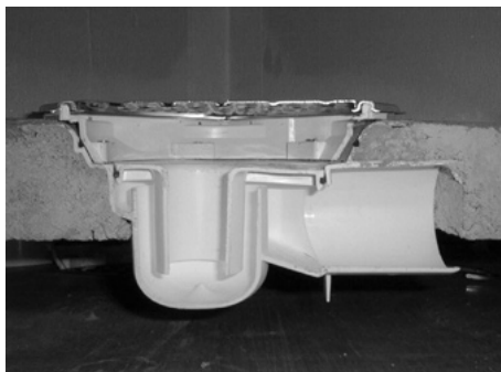
Kuva 2. Leikkaus lattiakaivosta, johon on liitetty vedeneriste.
