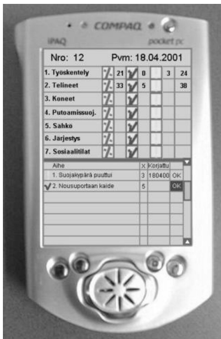
Kuva 2. Projektitietojärjestelmän mobiili päätelaitte. Esimerkkinä TR-mittauksen havaintojen syöttö työmaalla.
