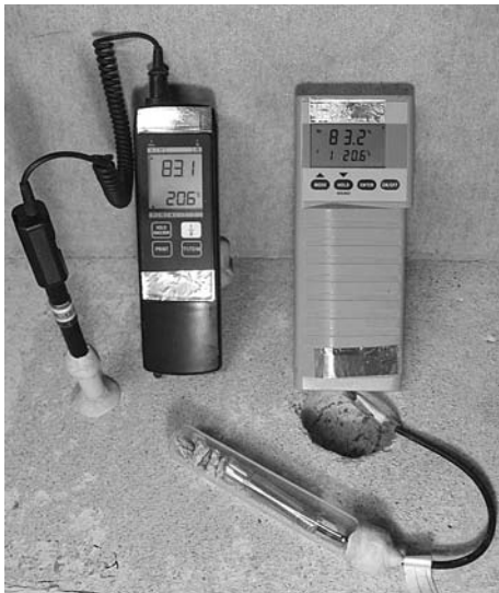
Kuva 2. Vasemmalla lukemienotto suhteellisen kosteuspitoisuuden mittapäistä, joka on asennettuna oikein valmisteltuun porareikämittausputkeen. Oikealla näytepalamittaus näyttölaitteen alla näkyvästä montusta otetuista betonimuruksista.
