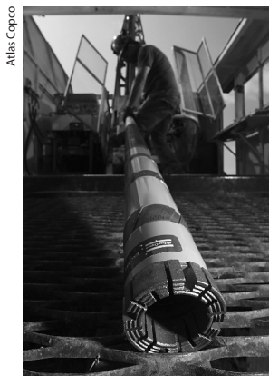
Kuva 2. Timanttikruunu, kalvaimet ja teräputki.
