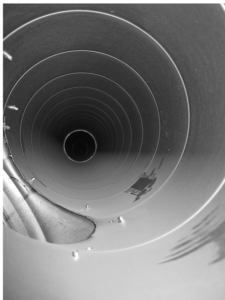
Kuva 4. Pintapölynäyte on juuri otettu järjestelmän sisäpinnalta. Mittaustulos ja visuaalinen arviointi kertovat järjestelmään kertyneestä rakentamisen aikaisesta pölystä.
