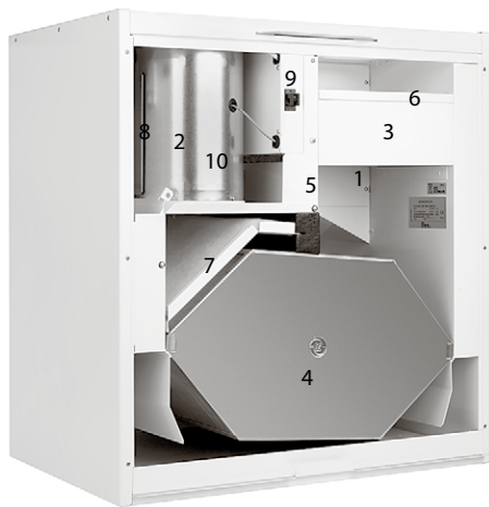
Kuva 2. Pientalon ilmanvaihtokone. 1 Poistoilmapuhallin (suojakannen takana), 2 Tuloilmapuhallin (poistoilmakanavan takana), 3 Ulkoilmasuodatin F7, 4 Lämmöntalteenottokenno, 5 Kesä-/talvipelti, 6 Ulkoilmasuodatin G4, 7 Poistoilmasuodatin G4, 8 Jälkilämmityspatteri (poistoilmakanavan takana), 9 Turvakytkin, 10 Lisälämmityspatteri (poistoilmakanavan takana). (Kuva: Vallox Oy).
