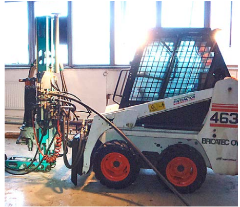
Kuva 2. Sisätiloissa käytettäviä kairakoneita, joilla voidaan ottaa maaperänäytteitä rakennuksen alta.
