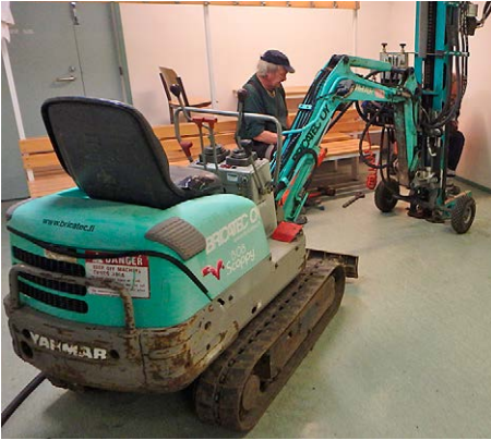
Kuva 2. Sisätiloissa käytettäviä kairakoneita, joilla voidaan ottaa maaperänäytteitä rakennuksen alta.
