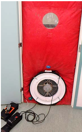
Kuva 4. Vasen: Sisäilman näytteenotto alipaineistetussa tilassa. Keskellä: Huokoskaasunäytteenotto etualalla ja taka-alalla pohjaveden pumppaus ennen näytteenottoa. Oikealla: Suojaputken sisällä oleva siiviläputki on suljettu EPS-palalla, jolloin ulkoilman pääsy mittaustilaan estyy.
