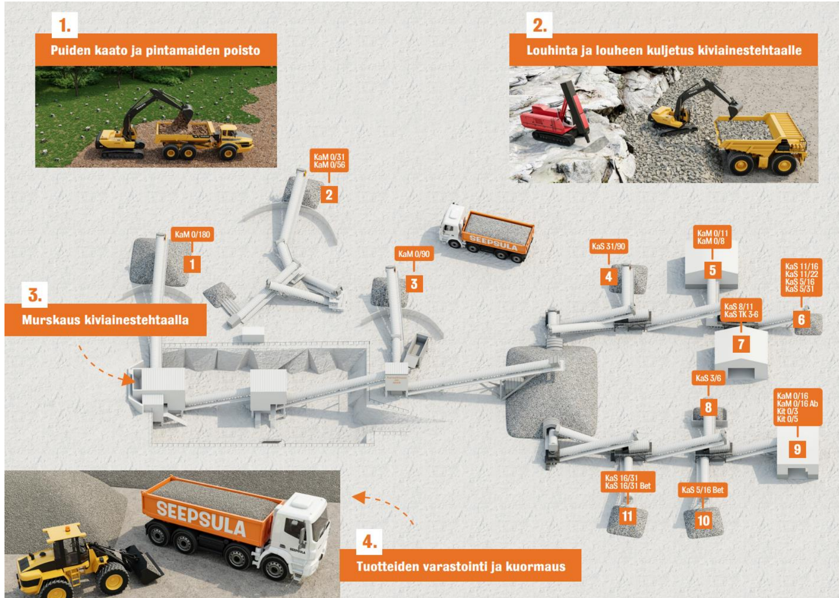
Kuva 1. Kiviainestueiden tuotantoprosessi.
