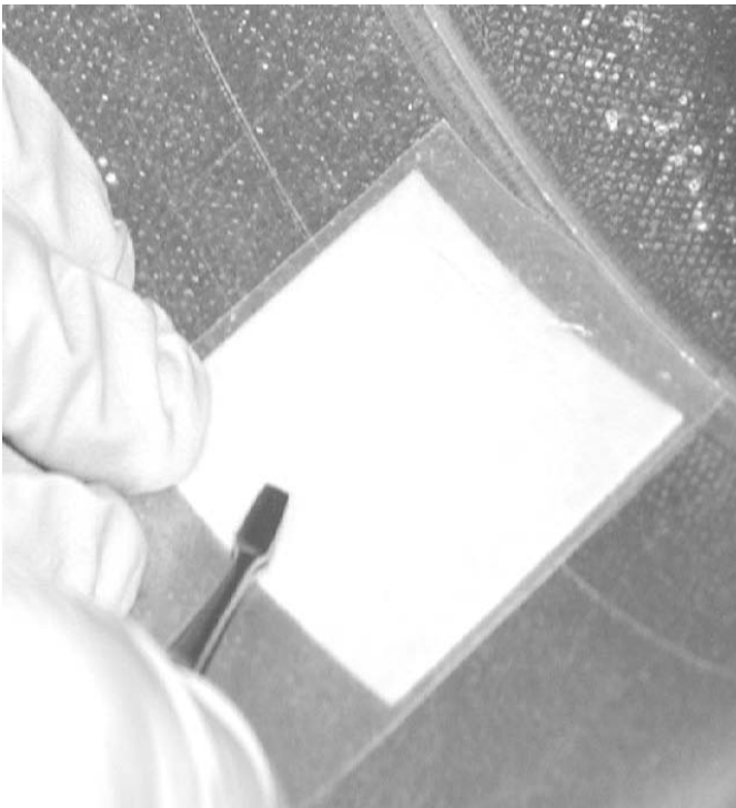
Kuva 1. Voiteluaineen näytteenotto ilmanvaihtotuotteesta suodatinimeytysmenetelmällä. Näytteenottimen painaminen pinseteillä.
